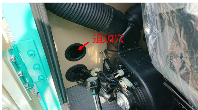
追加穴 運転席後部 オーガーリモコン配線用穴
